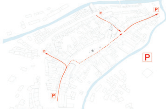
Dopravní koncept náměstí preferovaný průjezd mimo náměstí | těsně parkování na vohodech do území
