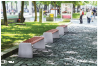
forma Masivně působící lavičky umístěné kolem kašny a v předprostoru kostela. Bočnice lze vyrobit z betonu nebo granitu s opěrákem či bez. Lavičky umístěné v prostoru jsou vhodnější bez opěráku, aby si uživatel mohl vybrat směr výhledu.
